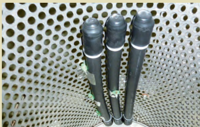
Testovací vzorky v kobaltové ozařovně
