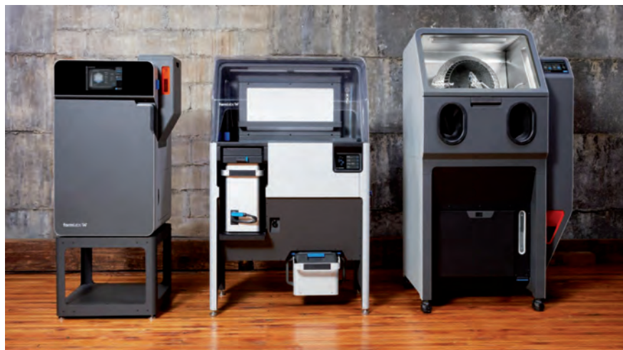
Díl se nejprve vytiskne z prášku v 3D tiskárně Formlabs Fuse (vlevo). Poté jej operátor očistí od zbylého prášku (uprostřed ve Fuse Sift; až 80 % nespotřebovaného materiálu se využije v další tiskové úloze). Nakonec se povrch může otryskat pro úpravu drsnosti (vpravo ve stanici Fuse Blast)
