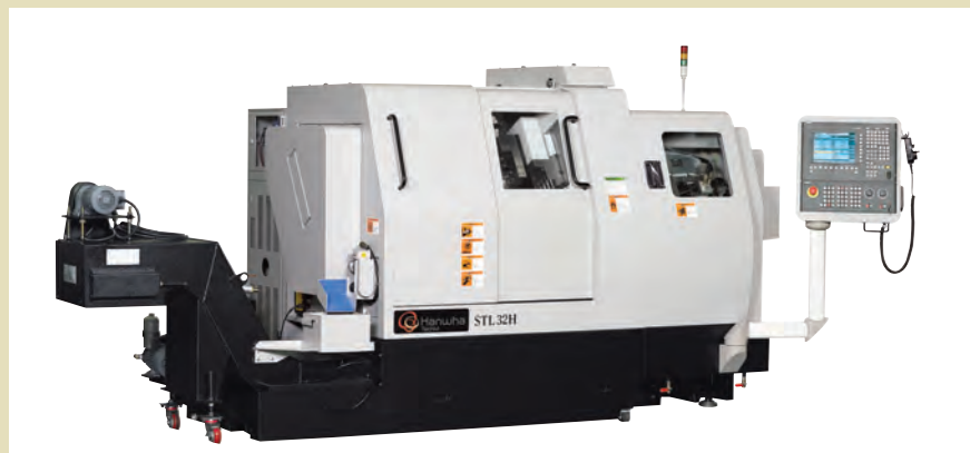
9osý CNC dlouhotočný automat STL32H nabízí zabudované motory hlavního i protivřetena pro vyšší přesnost, přímé pohony ve všech osách pro maximální tuhost a plně řízenou osu C.
