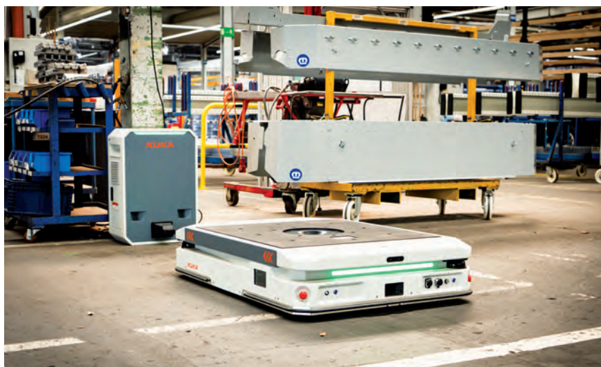
Nabíjení mobilních robotů KMP obstarává mj. konduktivní dokovací stanice
