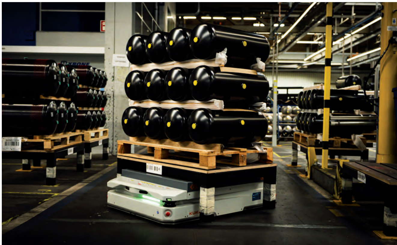
Mobilní robot KMP 1500P dodává 100litrové tlakové nádoby do svařovací stanice s centimetrovou přesností
