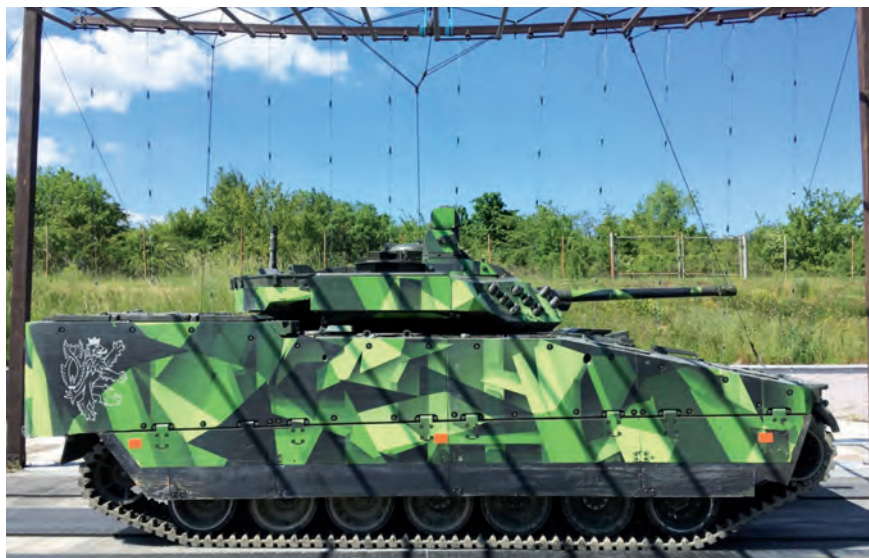
V květnu a červnu letošního roku proběhly v Akreditované zkušební laboratoři č. 1103 v odstěpném závodě VTÚPV ve Vyškově v rámci funkčních zkoušek pásových bojových vozidel pěchoty pro Armádu ČR také zkoušky elektromagnetické kompatibility
