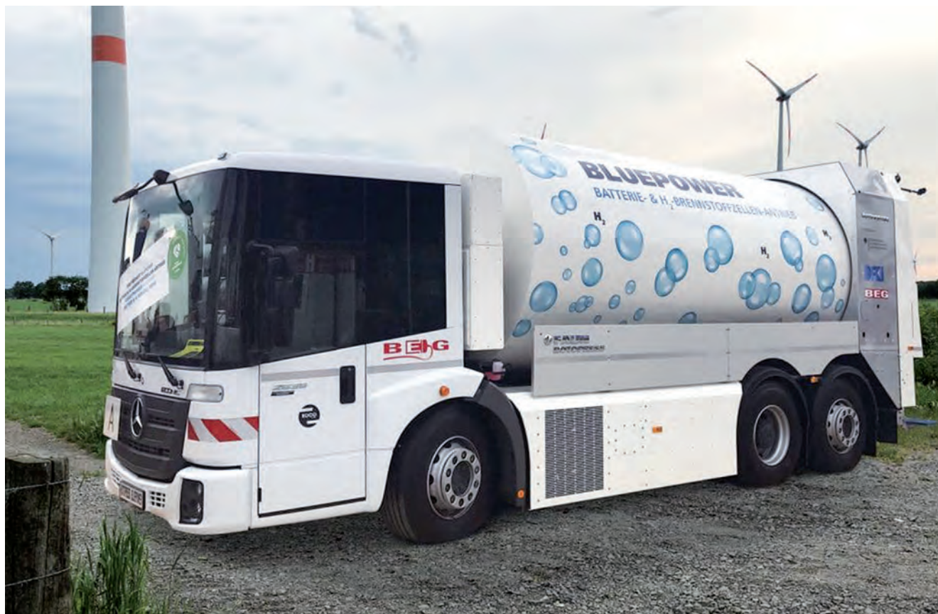
Vozidlo Faun Bluepower Community, určený pro sběr komunálního odpadu ve městech, má plně elektrický podvozek s bateriemi (s celkovou kapacitou 85 kWh a hmotností 960 kg) a dále alternativně s jedním až třemi vodíkovými palivovými články (s kapacitou 100 až 300 kWh) jako prodlužovači dojezdu "Range Extender". V nejsilnější verzi činí dojezd 560 km.
