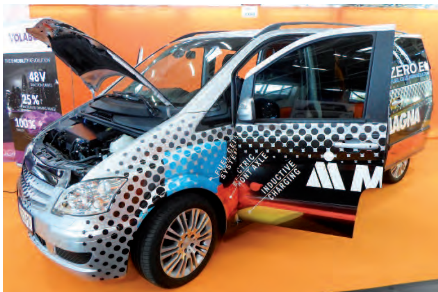
Vyznamenaný FCREEV - elektromobil na bázi Mercedes Viano s vodíkovým palivočlánkovým prodlužovačem dojezdu 25 kW "Hy Range," společný projekt Magna Steyr Engineering a PROTON MOTOR Fuel Cell GmbH - firmy, která se podílela na prvním českém vodíkovém autobusu TriHyBus
