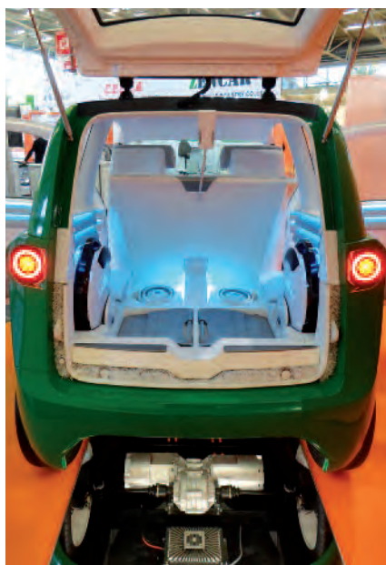
Koncept MEET firmy MAHLE s intuitivním ovládáním, důrazem na efektivnost při minimálních nákladech, pohonná jednotka pracuje s napětím 48 V
