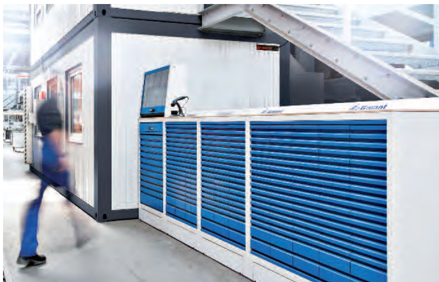
Systém pro výdej nástrojů u Německých drah (DB Fahrzeuginstandhaltung GmbH)
