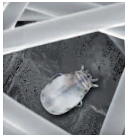
Prachový roztok uvězněný na nanotkanině jako na trampolíně – nad ním pro srovnání velikost běžného mikrovlákna, které pro roztoky nepředstavuje žádnou překážku.
